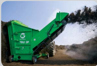
...► TBU 3 P im Einsatz: Umsetzung von Trapezmieten bis 3 m mit 0,5 km/h u. mehr
