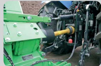
...► Anschluss durch stabile Powerdrive-Gelenkwelle mit Überlastungskupplung
