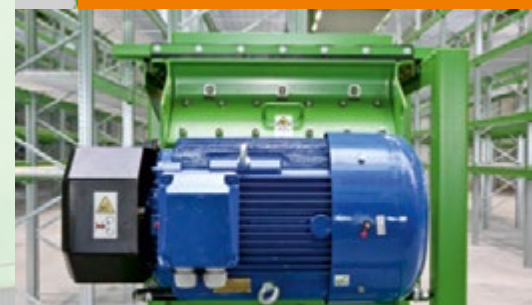
Kraftvoller Elektromotor mit 45 KW für Durchsatzmengen bis 30 m³/h
