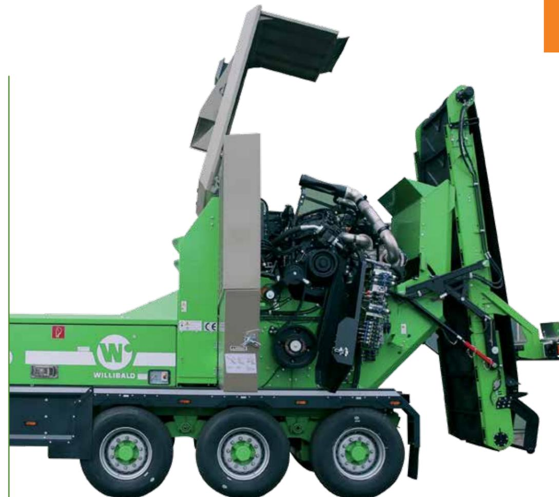
Materialaustragung mittels Gummitransportband 3,8 bzw. 4,5 Meter Abwurfhöhe wählbar
