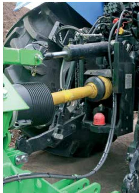
Anschluss durch stabile Powerdrive-Gelenkwelle mit Überlastungskupplung
